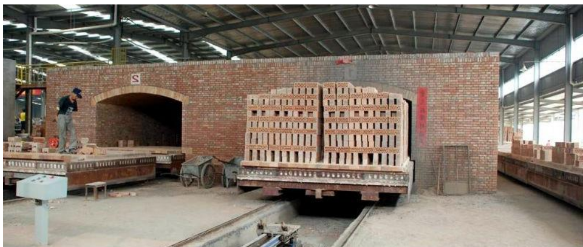
Figura 12. Secadero tipo túnel de 2 cámaras
