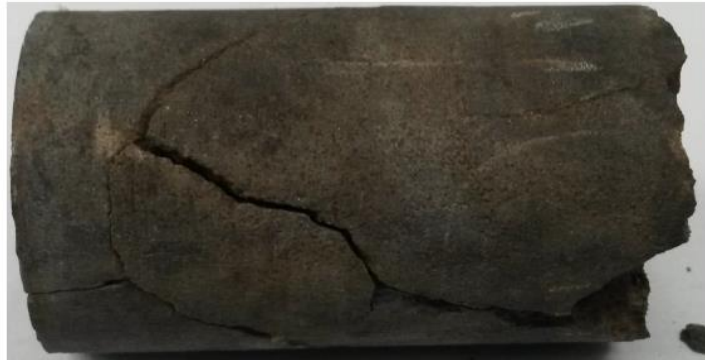
Figura 37. Plug después de ser sometido al secado
