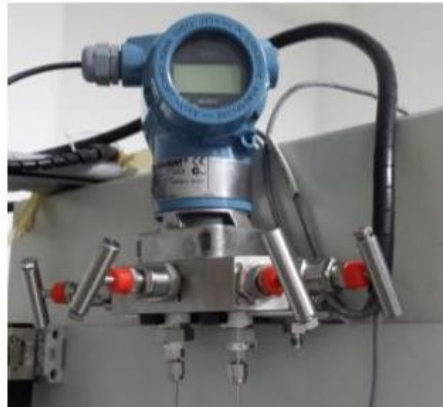
Figura 23. Transductor de registro de medidas.
