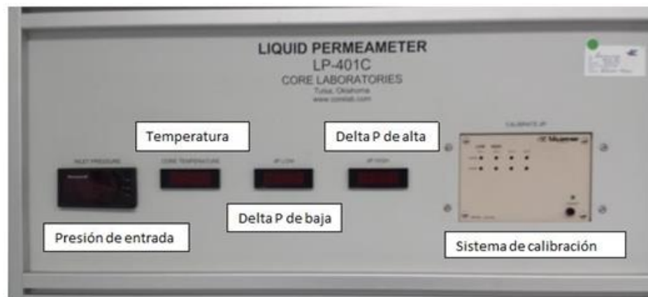
Figura 22. Panel de registro de medidas y calibración de transductores.
