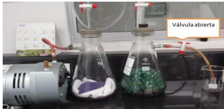
Figura 18. Montaje saturación del Núcleo
