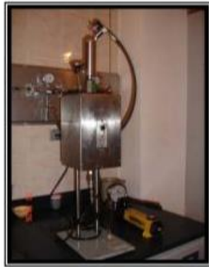
Figura 8. Montaje de prueba PPT y Discos de aloxita
