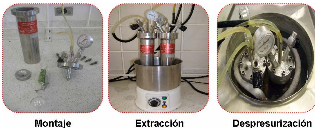
Figura 12. Etapas de la extracción con fluido supercrítico.
