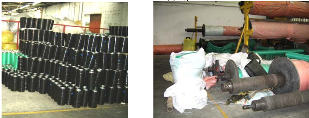
Figura 29. Almacenamiento inadecuado de bobinas y plegadores de urdimbre
