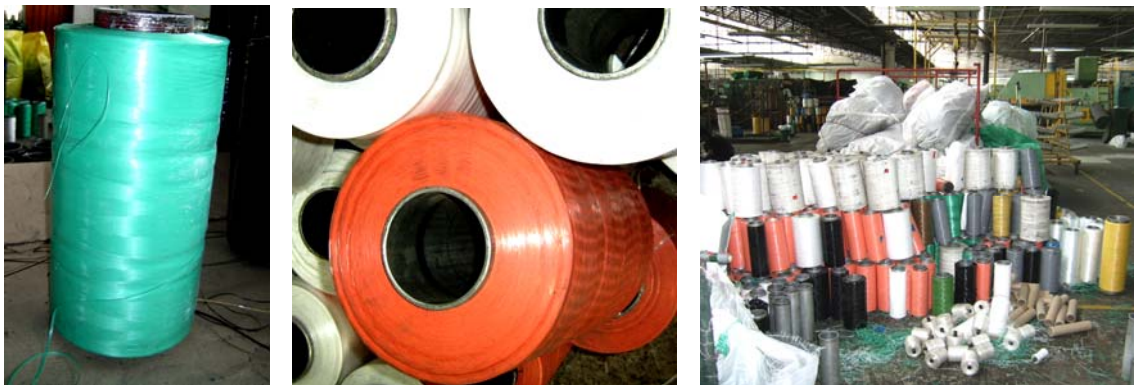
Figura 24. Fotografías de bobinas de cinta fibrilada, muy tensionada y arrume de bobinas defectuosas
