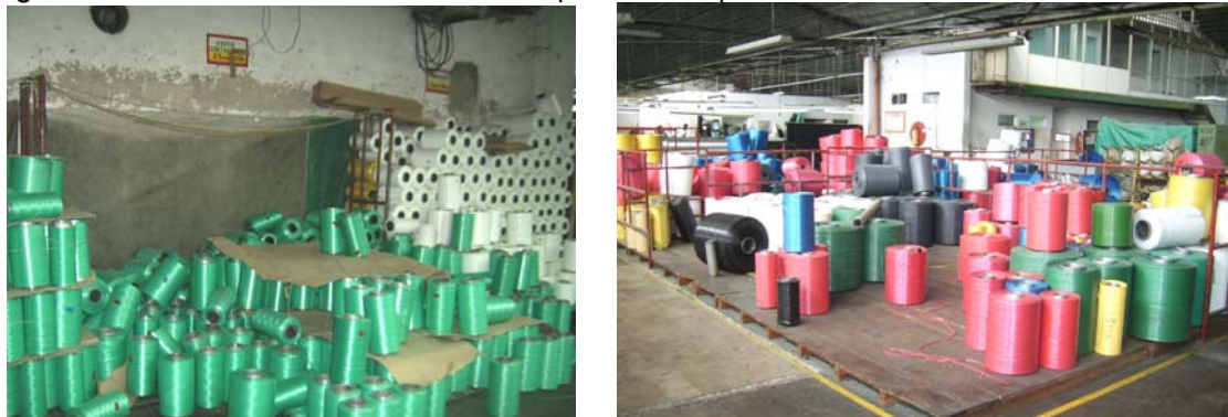
Figura 27. Almacenamiento inadecuado de producto en proceso.
