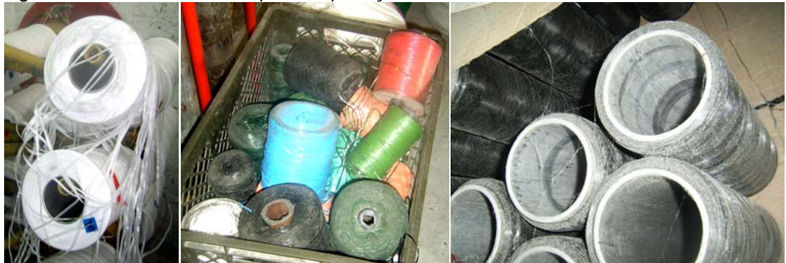
Figura 26. Material deteriorado por transporte y almacenamiento inadecuado.
