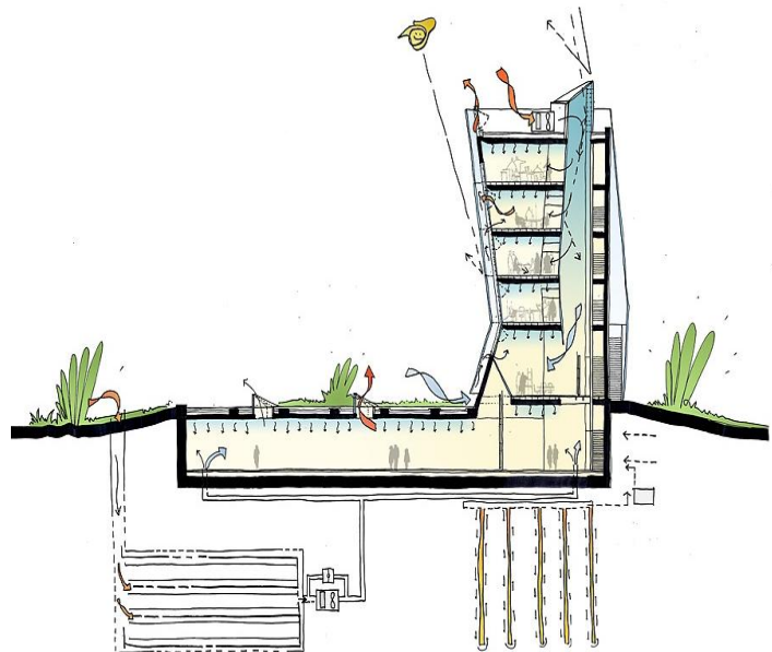
Figura 9. Aislamiento térmico y ventilación del edificio. A la izquierda, doble fachada del edificio [378] y a la derecha, ventilación natural de la edificación[381].
