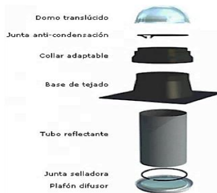
Figura 5. Elementos que conforman un tubo solar [344].
