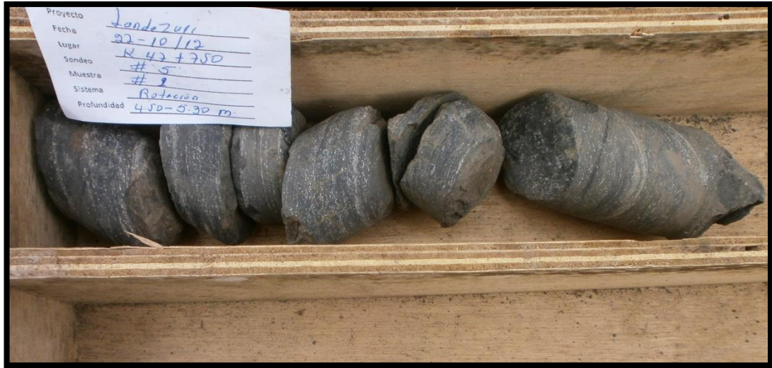
Fotografía 13. Sondeo No. 1 – Muestra No. 1 (Detalle rotación)
