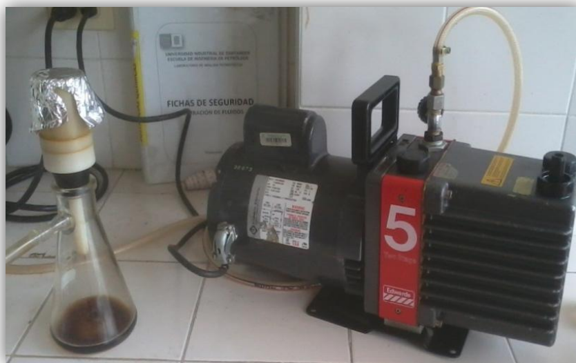
Figura 31. Montaje ASTM D2007-80.
