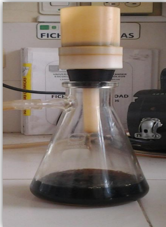
Figura 30. Montaje de embudo Büchner y erlenmeyer con salida lateral.
