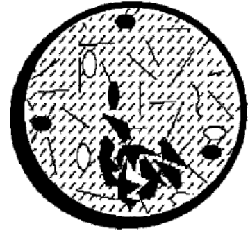
Figura 11. Floculación y precipitación de componentes pesados mediante la adición de un solvente miscible no polar.
