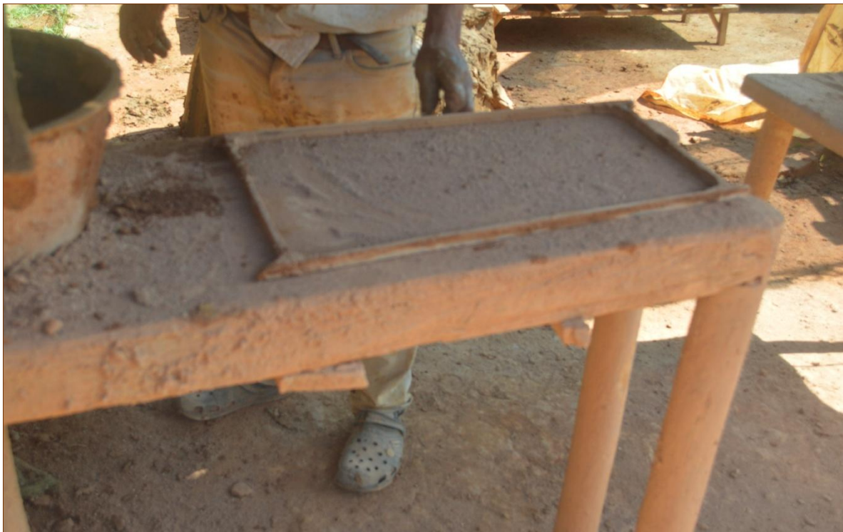
Formaleta de metal con tierra seca para extender el barro y formar la teja sin que se pegue
