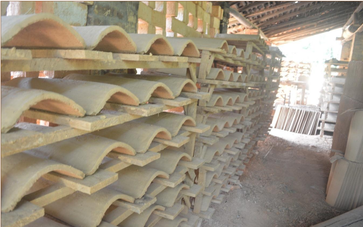
Tejas acomodadas en camaretas cerca al horno para empezar a quemar y hacer el encasillado
