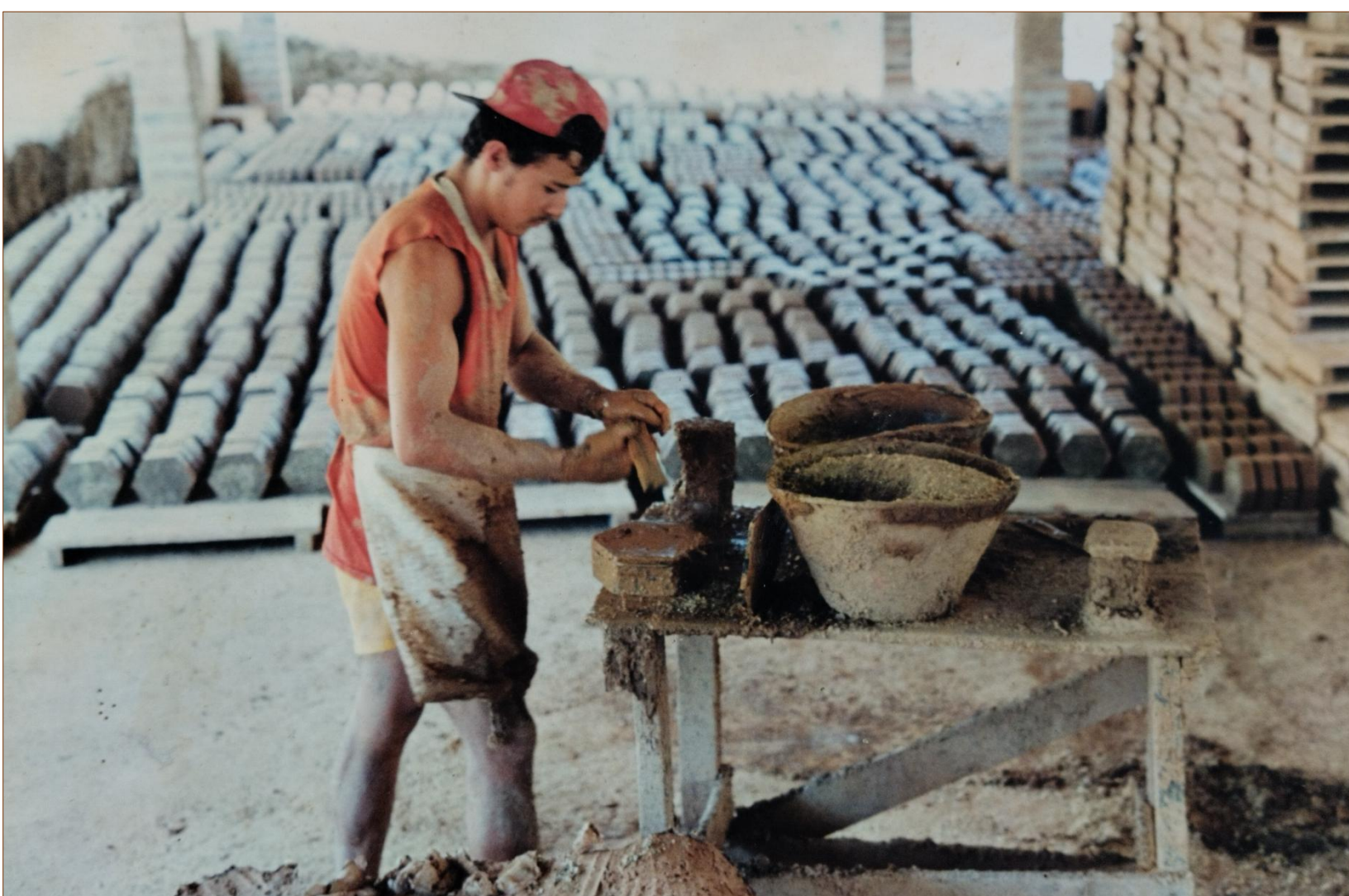
Archivo fotográfico 3 Arcilla y Tradición. 2004. Moldeado y corte de toletes octogonales
