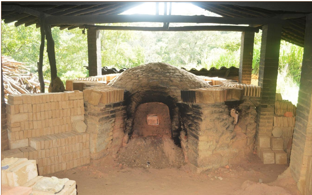
Horno en proceso de cocción (quema) sellado con barro y toletes
