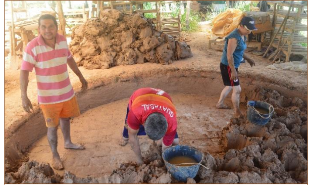
Proceso de extracción del barro. Se va remojando y divide con manos y pies para extraer grandes cantidades
