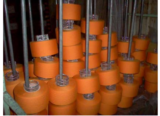
Fotografía de hilaza en niquelina después de haber salido de la olla de teñido.
