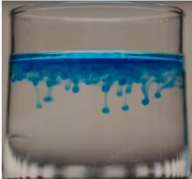
Figura 9. Inestabilidad Rayleigh-Taylor presentada por fluidos de diferentes densidades, en azul fluido más pesado - Youtube: https://youtu.be/yabqo7VFTYs .
