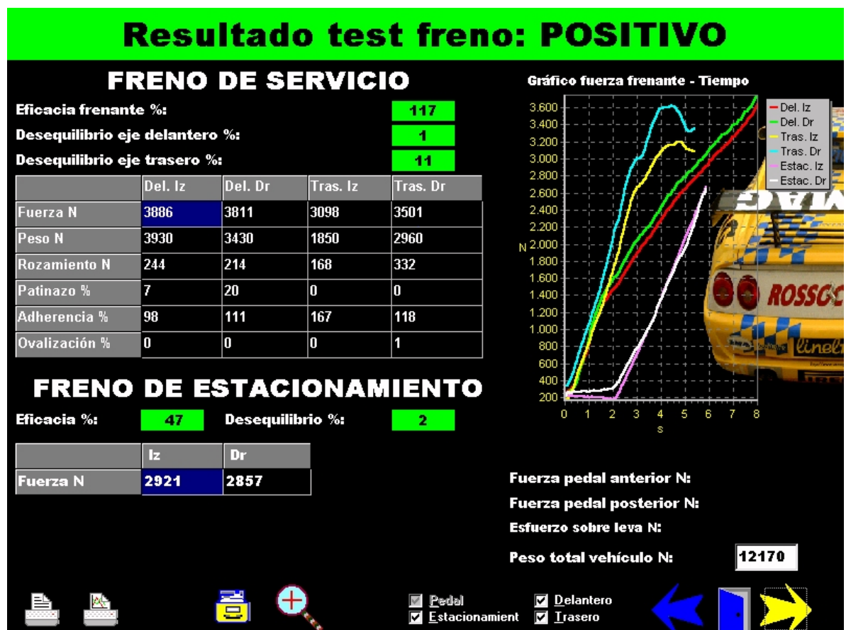
Figura 19. Resultados de una prueba completa realizada en el frenómetro. Fuente: CDA Motocesar S.A.S. Departamento Técnico (2017).
