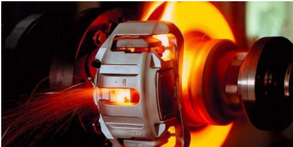
Figura 11. Recalentamiento de los discos de frenado. Fuente: PULLE, encontrar en la dirección web: http://www.puller.su/uploads/files/images/katalog/torm_kolodki/tormozk_14.jpg . 04 de mayo del 2017.
