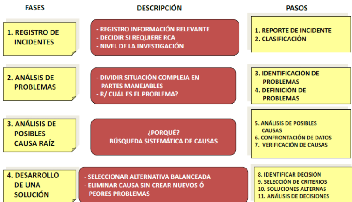
Figura 16. Análisis de falla, causa. Diagrama del proceso general de RCA Fuente: SERNA, Aníbal José, presentación de análisis de falla, 2015 Bucaramanga: Universidad Industrial de Santander.
