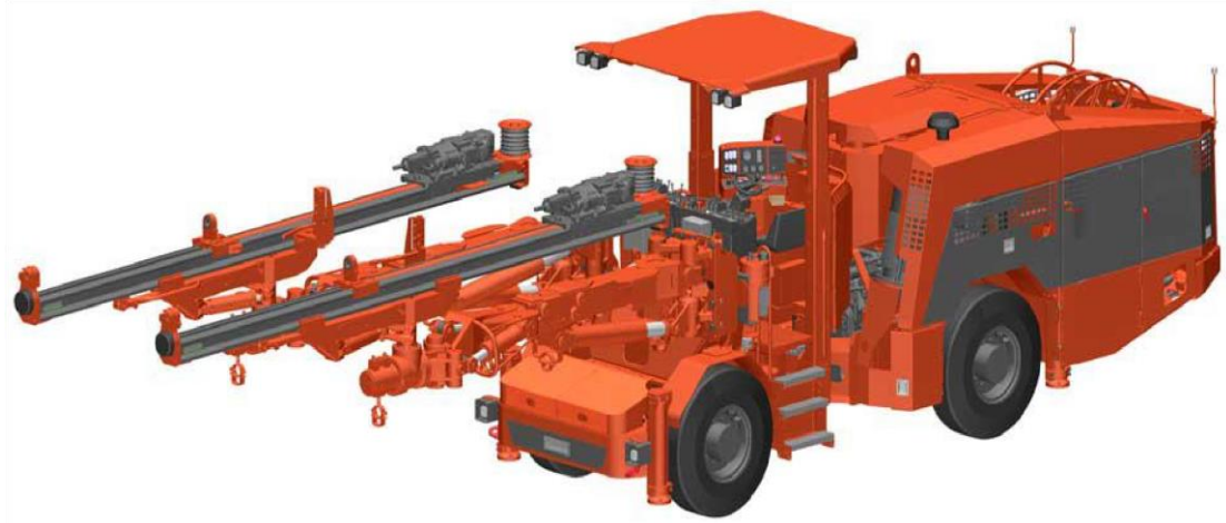
Figura 7. Isométrico jumbo de perforación Sandvik DD321-40
