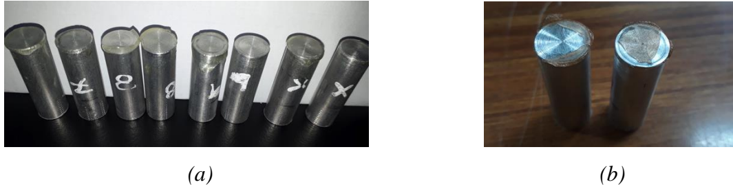
Figura 14. (a) y (b) Falla del adhesivo en probetas de carga axial.
