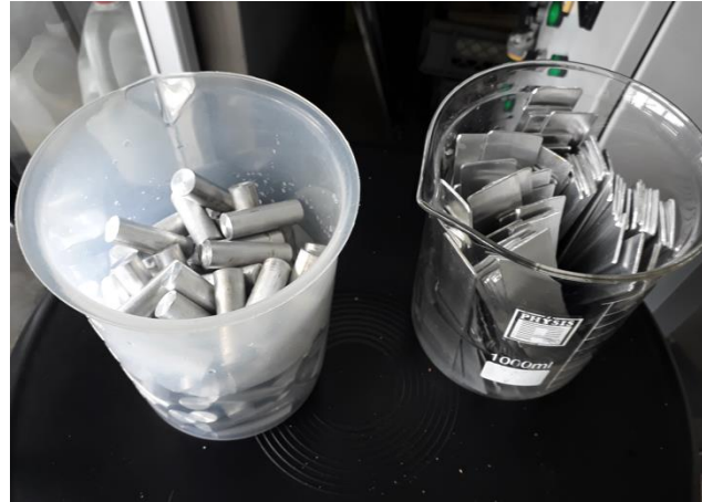
Figura 6. Sustratos de aleación de aluminio 6063, para ensayos de carga axial y de cizallamiento.
