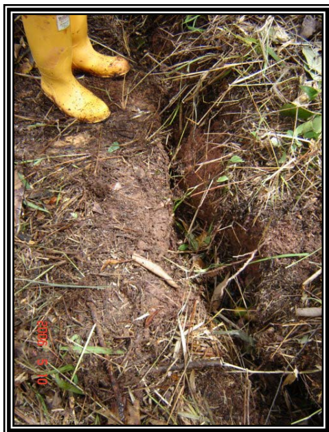
Figura 5. Grietas de tensión escalonadas y abiertas.
