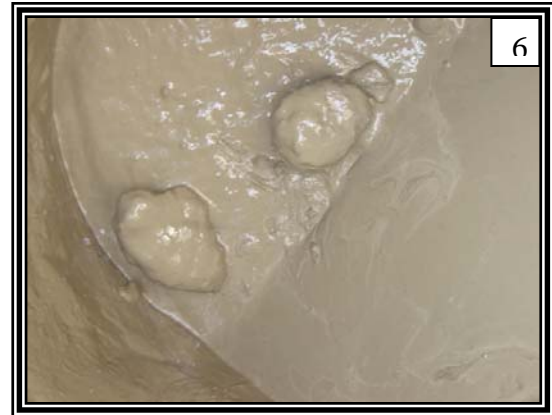
6. Detalle de los grumos de cemento que se forman al batir la mezcla.
