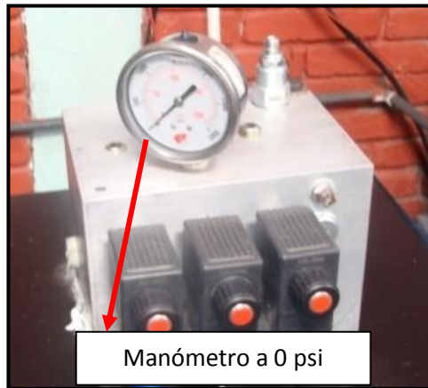
Figura 91. Autobloqueo de la carga. Fuente: Los autores.
