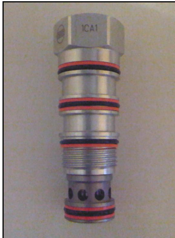
Figura 59. Válvula de cartucho DOFS-XHN. Fuente: Los autores.
