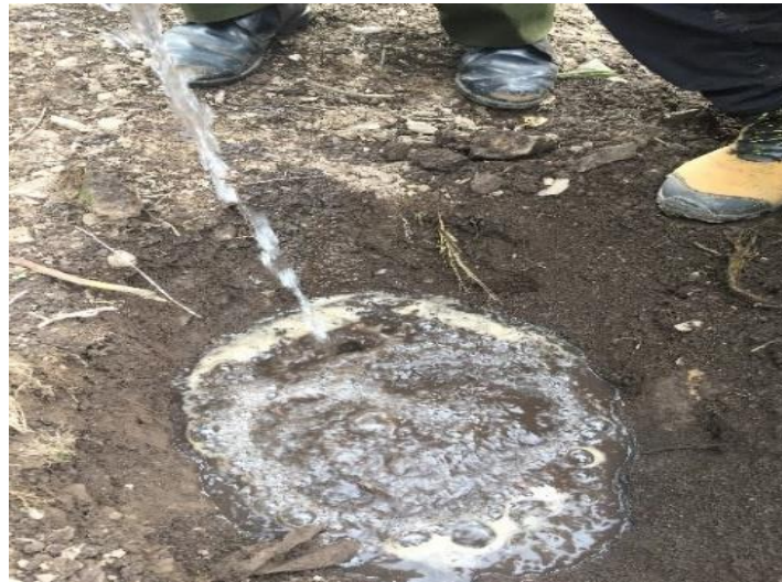
FIGURA 15. Prueba de Permeabilidad
