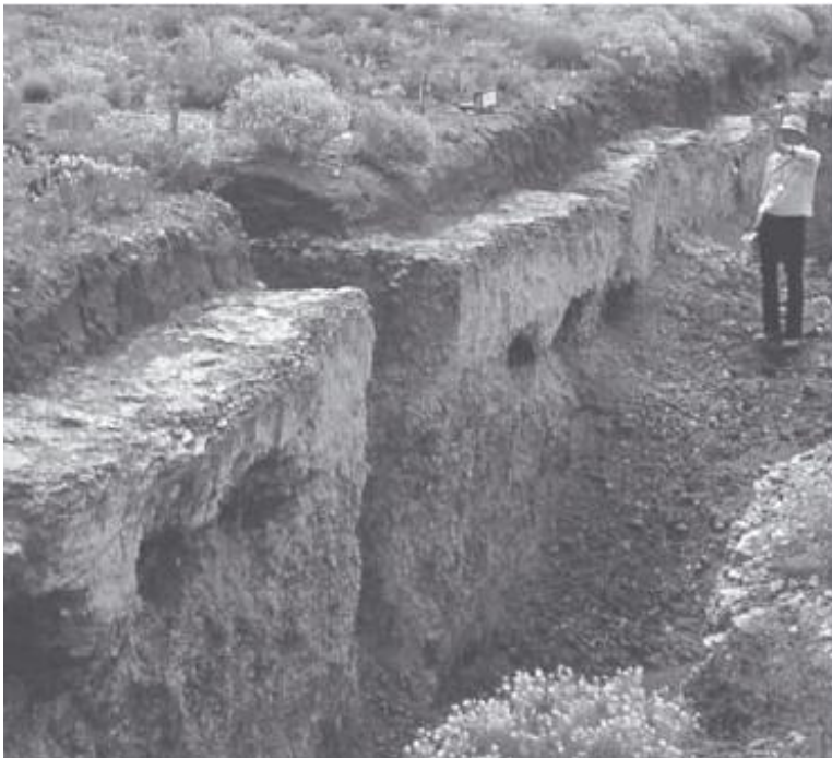
Figura 16. Nivel de calcreta masiva en el área de Las Cruces, Nuevo México.
