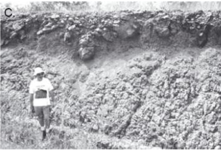
Figura 21. Perfil de ferricreta expuesto al sur de Palika, cerca del Río Gambia, Gambia, Occidente de África.
