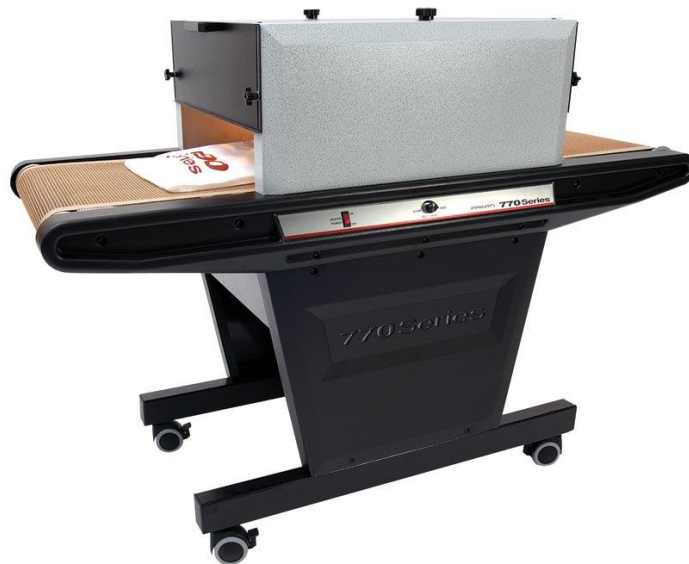
Figura 42. Horno de curado para estampación textil.
