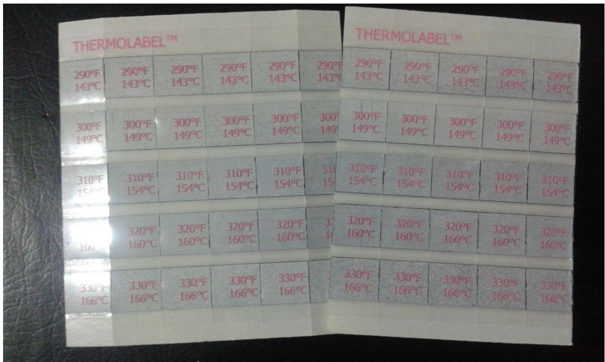
Figura 107. Tiras de registro irreversible de temperatura.
