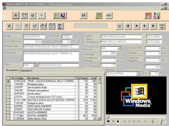
Este software es la herramienta para la implementación de Sistema Modular de Producción en la planta de confección, que permitió la realización de los respectivos balanceamientos de planta de acuerdo a la producción programada, teniendo en cuenta las diferentes variables que afectan dicha labor: recurso humano, maquinaria, cantidades, referencias, preferencias de los clientes, elaboración de muestras, el impacto generado por estos y la estrategia a seguir para controlarlos, entre otros.
