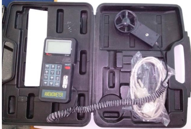
Figura 16. Anemómetro dwyer modelo 8904.
