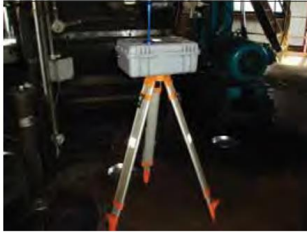
Figura 2. Dispositivos electrónicos portátiles de medición de polvo.
