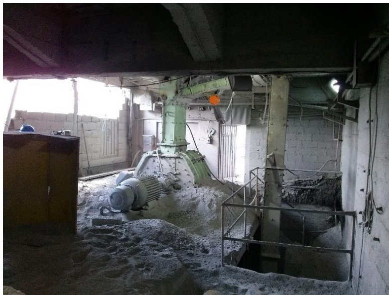
Figura 24. Trituradora de martillos
