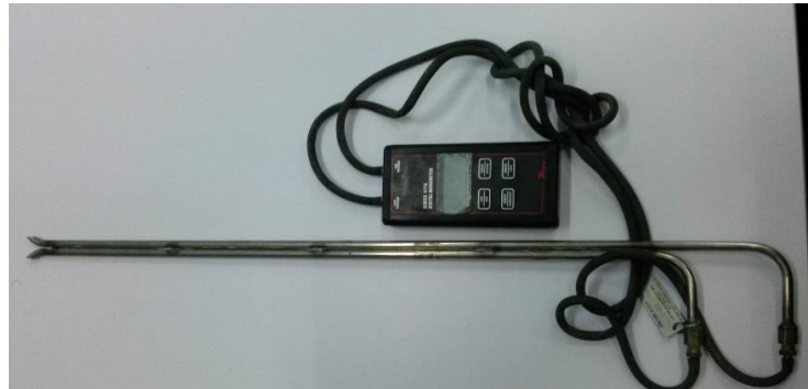
Figura 18. Manómetro Dwyer serie 477 B
