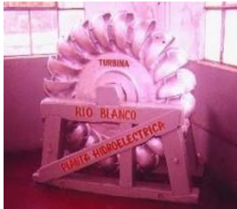
Fotografía 2. Rodete y cuchara de una turbina PELTON
