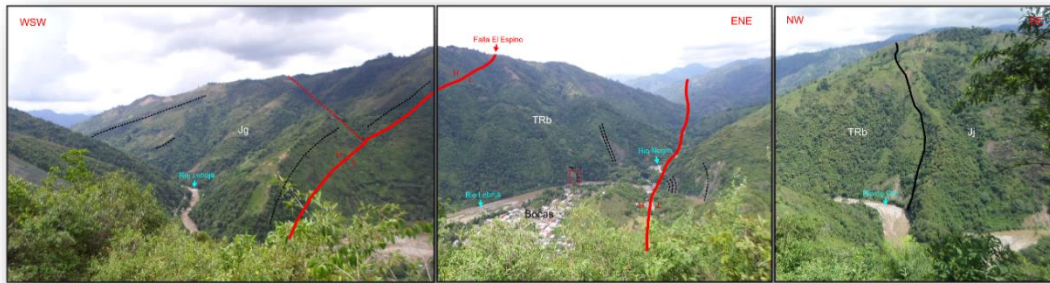
Figura 51. Vista panorámica desde la Cuchilla El Espino hacia el norte de la localidad de Bocas, tomada desde la estación Doboc 06. En rojo macizo e interlineado se resaltan los datos de fallas y lineamientos respectivamente, en negro macizo los contactos litológicos y en negro interlineado se resaltan la disposición de los estratos.
