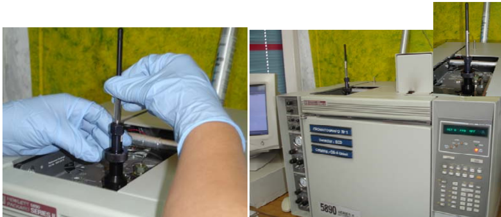
Figura 18. Desorción térmica de la fibra en el puerto de inyección (split 1:10, 250°C) del cromatógrafo de gases equipado con ECD y columna DB-5 (30 m).
