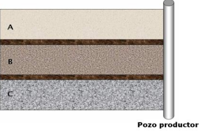
Figura 2. Esquema de yacimiento homogéneo estratificado.
