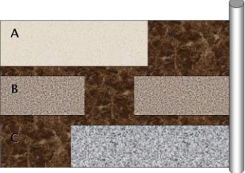
Figura 4. Esquema de yacimiento heterogéneo discontinuo.
