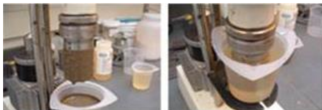
Figura 10. Remoción con malla metálica y viscosímetro Fann 35. Tomado de: Instructivo de cementación. Gerencia general de perforación y completamiento well delivery process. Ecopetrol S.A.
