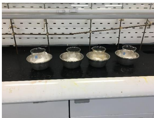
Figura 4. Síntesis de peróxido de magnesio ( \text{MgO}_2 ). Reactor en cámara de gases, durante baño de hielo.
