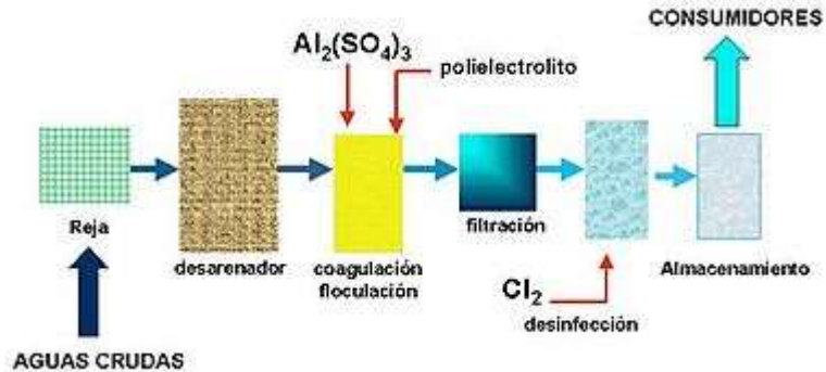
Figura 3. Esquema de sistema de potabilización de agua
