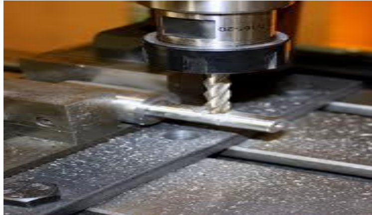
Figura 7: Taladrado hueco pin. (Similar para eje pasador satélite).
