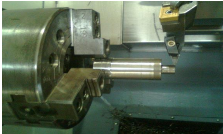
Figura 6: Proceso de torneado barra acero SAE 8620
