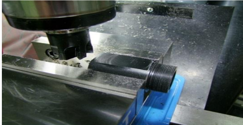
Figura 8: Proceso fresado caras planas. (Similar para eje pasador satélite).
