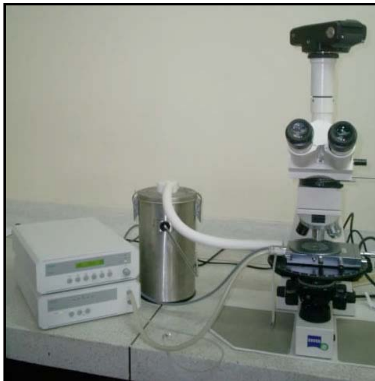
Figura 5. Aspecto del equipo utilizado para el estudio de las Inclusiones fluidas (Platina de calentamiento-enfriamiento TH600 marca LINKAM). Escuela de Geología. Sede Guatiguará, UIS.
