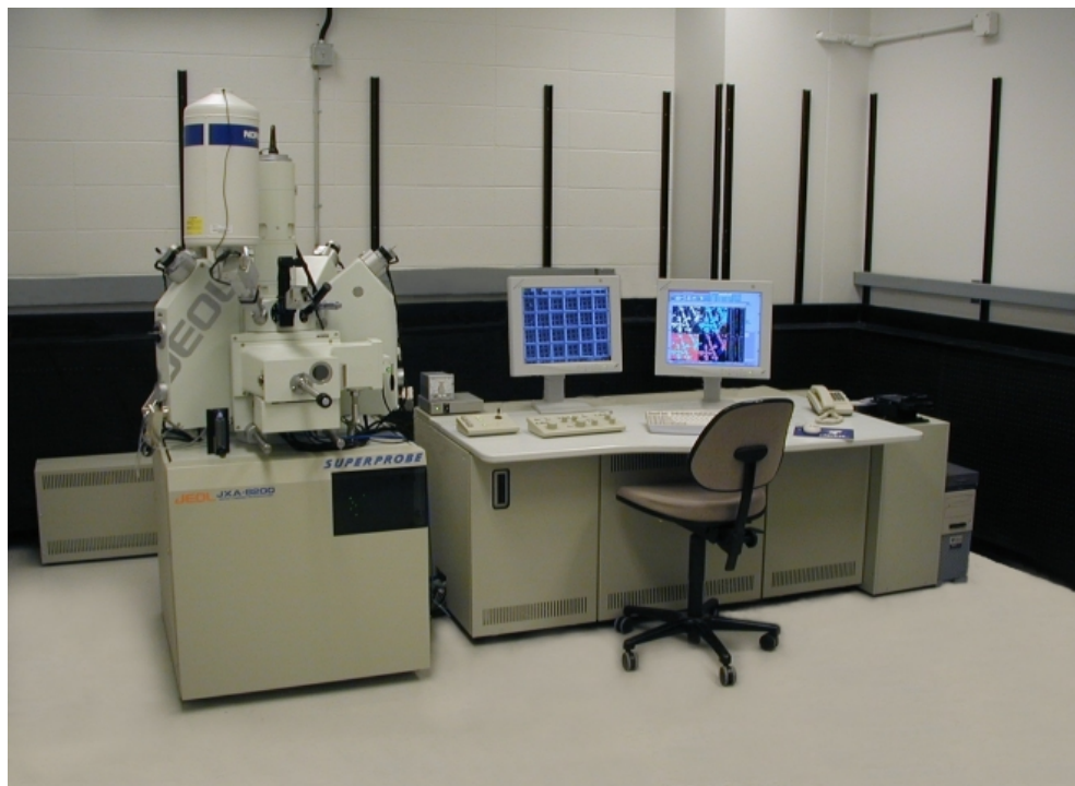
Figura 3. Aspecto de la microsonda electrónica JEOL JXA-8200. Laboratorio UCLEMA. Universidad de Calgary, Canadá. Tomada de http://www.geo.ucalgary.ca/UCLEMA/ .
