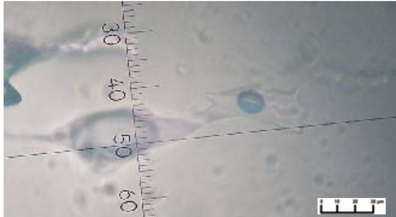
Figura 63. Cristal de esmeralda. Inclusión secundaria. Aumento de objetivo de 40x. Inclusión que ha sufrido un necking – down , produciendo dos burbujas gaseosas. Muestra COR 008 001 (Minas de San Pedro, zona I).
