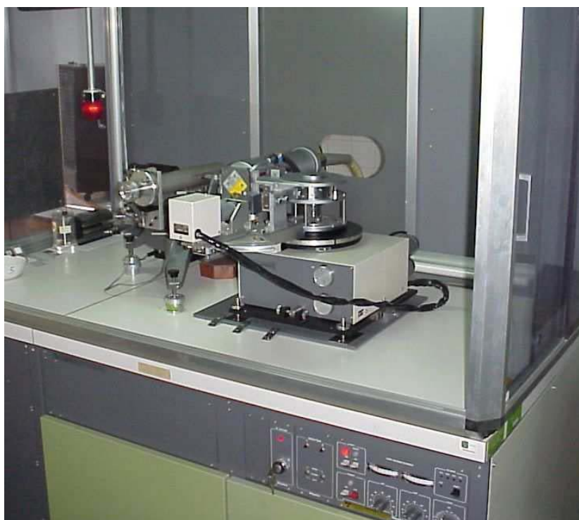
Figura 4. Aspecto del difractómetro de rayos X marca RIGAKU D/MAX IIIB. Laboratorio de Difracción de Rayos X. Escuela de Química, UIS.
