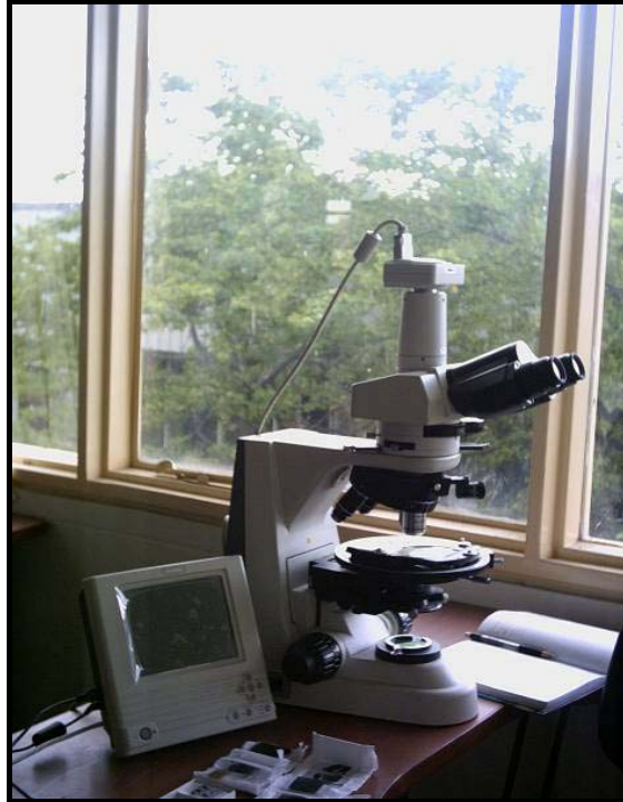
Figura 2. Aspecto del microscopio de luz transmitida Nikon Eclipse-50i con cámara fotográfica DS-L1. Laboratorio de Microscopía Óptica. Escuela de Geología. UIS.
