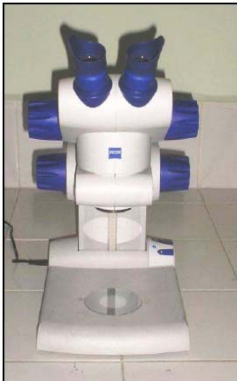
Figura 1. Aspecto de la Lupa estereoscópica Carl Zeiss Jena. Laboratorio de Arcillas, Escuela de Geología. Universidad Industrial de Santander (UIS).
