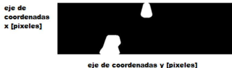
Figura 3.8. Segmentación de vehículos en movimiento
