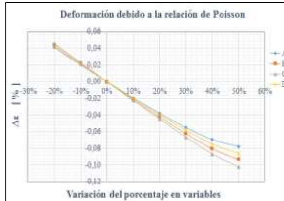
Figura 10. Gráfica deformación debido a la relación de Poisson
