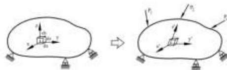
Figura 1. Proceso de deformación de un elemento.
