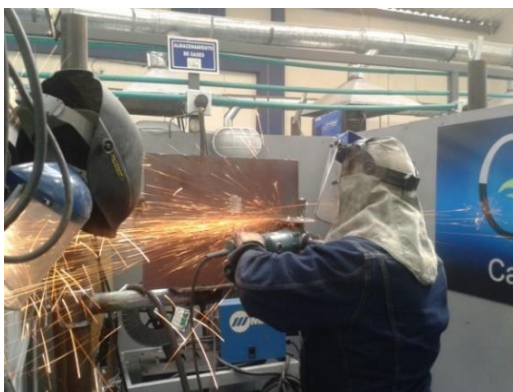
Figura A 3. Procedimiento de limpieza con disco abrasivo
