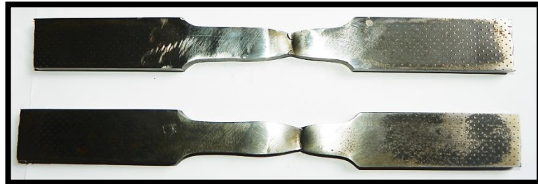
Figura 17. Probetas de tracción del metal soldado luego de la falla.
