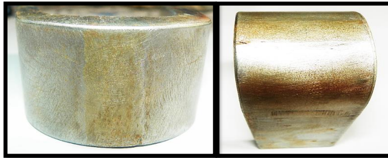
Figura 16. Probetas de doblez del metal soldado luego del ensayo
