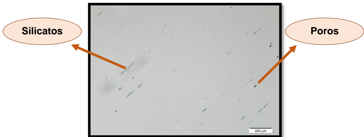
Figura 2. Micrografía de inclusiones no metálicas. (Sección longitudinal, 100X, sin ataque).
