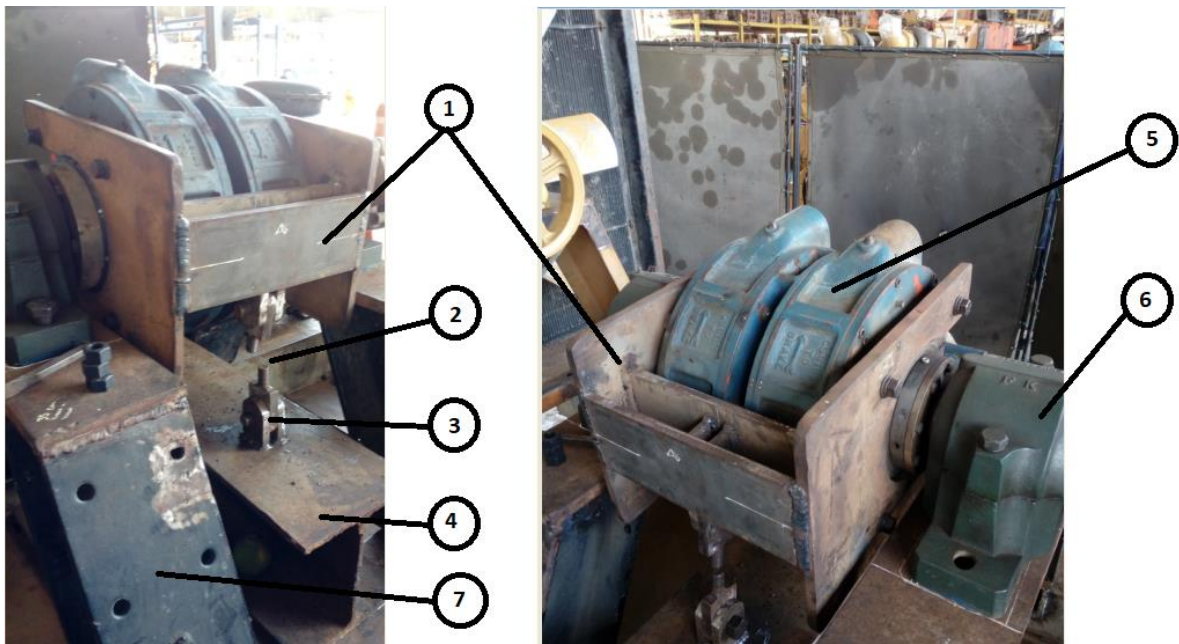
Figura 58. Montaje y acondicionamiento del freno hidromático como dinamómetro hidráulico
