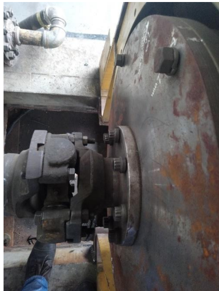
Figura 62. Junta universal cardan-volante y acople rígido entre el volante y la catarina del motor
