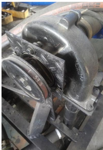
Figura 39. Nueva bomba primaria o principal
