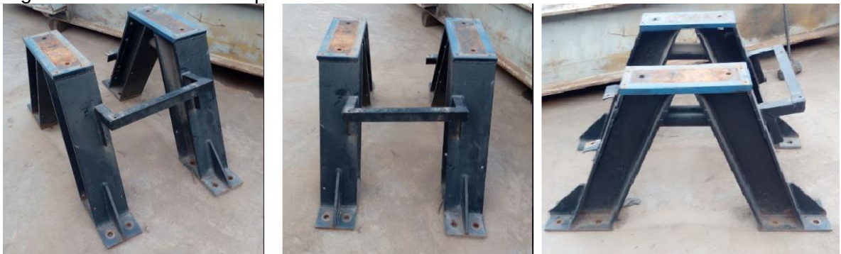
Figura 28. Estructura base para el dinamómetro hidromático.
