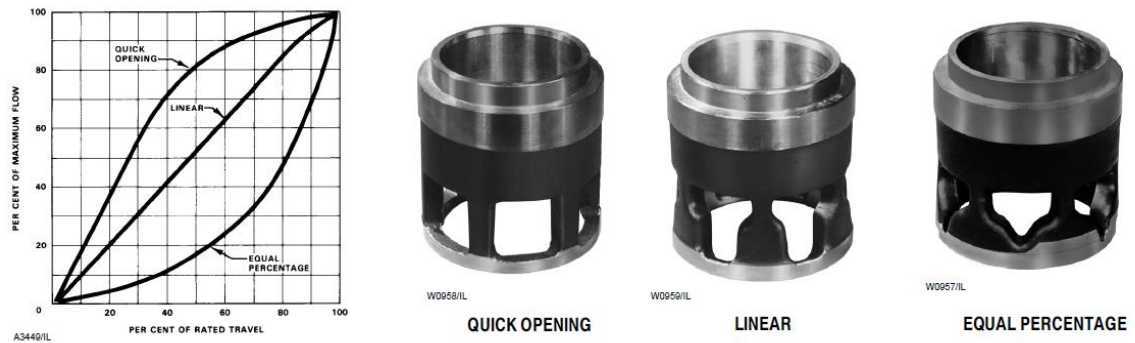
Figura 38. Curva de apertura de válvula Fisher
