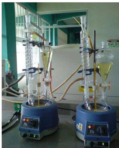
Figura. Montaje de reacción para la síntesis de TiO 2 -Ln
