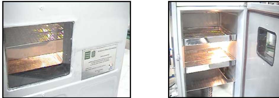
Figura 8. Cámara de secado y sistema de iluminación vista externa
