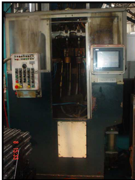
Figura 15. Templadora TOCCO I
