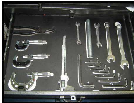
Figura 51. Estándar de herramientas para los tornos Mazak y Okuma
