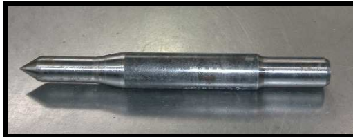
Figura 33. Dispositivo de alineación del contrapunto y el trípode localizador
