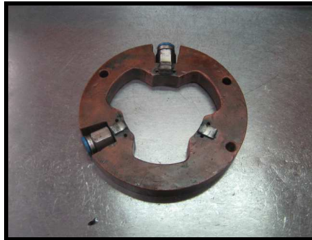
Figura 29. Plato soporte para la tulipa Vitara Macho
