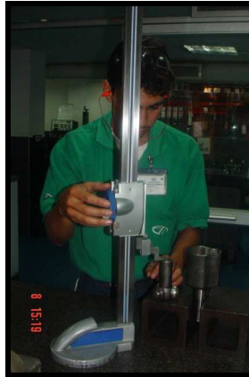
Figura 25. Medición del fondo de pista de la tulipa
