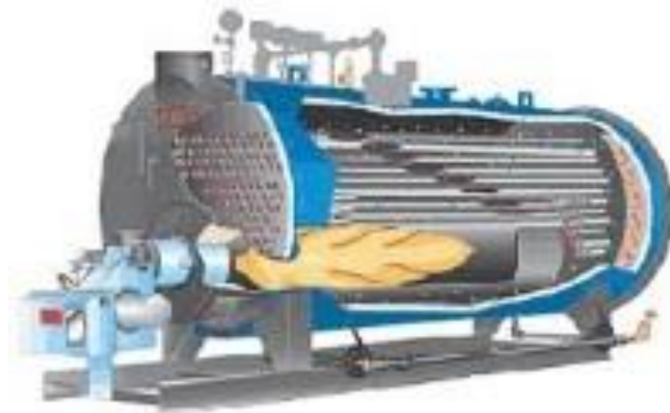
Figura 7. Diagrama de funcionamiento caldera Piro-tubular
