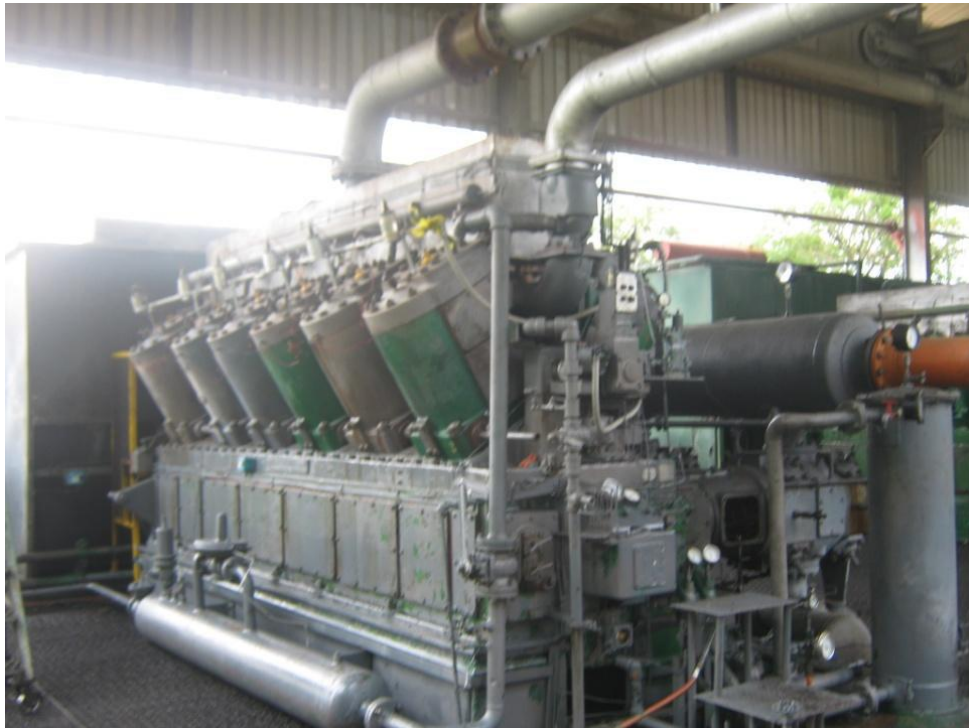
Figura 7. Compresor INGERSOLL de baja (LP1) campo Cicuco.
