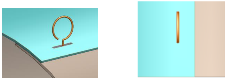
Figura 60. Compuerta en estado normalmente abierto.
