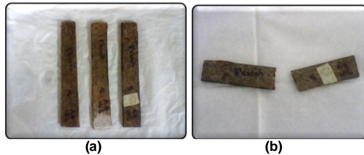
Imagen 9. Probetas para el ensayo de flexión. (a) Probetas antes del ensayo; (b) Probetas después del ensayo.
