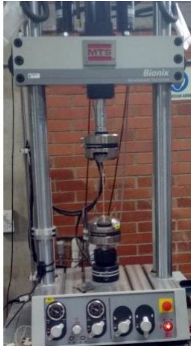
Figura 7 Ensayo a tracción del hilo en la MTS con la Norma ASTM-D2256.
