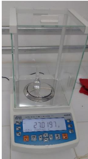
Figura 6 Peso de hilo + picnómetro con agua destilada.
