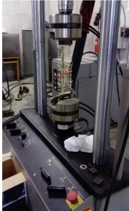
Figura 8 Ensayo a tracción del tejido en la MTS con la Norma ASTM-D4631-9.
