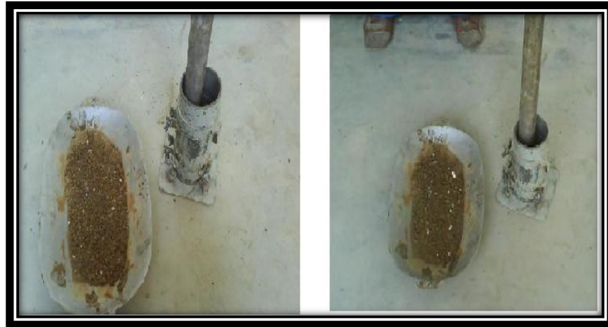
Figura 20. Muestra con humedad óptima lista para compactar
