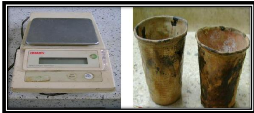
Figura 22. Balanza y taras para hallar la humedad en las muestras
