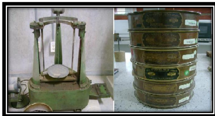
Figura 4. Tamizadora eléctrica y serie de tamices N°10 a N°200
