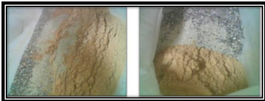
Figura 14. Mezclado de la dosificación 25% finos – 75% arenas para elaborar la probeta
