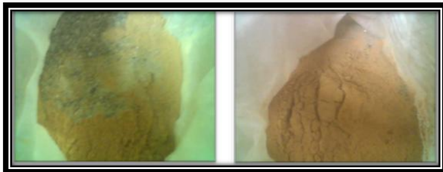
Figura 15. Mezclado de la dosificación 40% finos -60% arenas para elaborar la probeta
