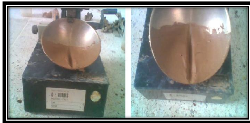
Figura 9. Colocación de muestra en cazuela y elaboración de ranura
