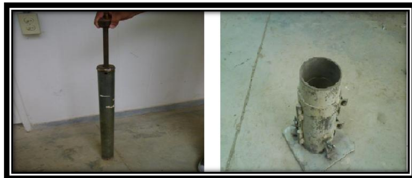
Figura 19. Martillo compactador y molde para prueba de pretor modificado
