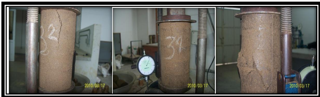
Figura 31. Fallas producidas en las probetas con dosificación 25% finos-40% arenas del suelo con IP. 8.
