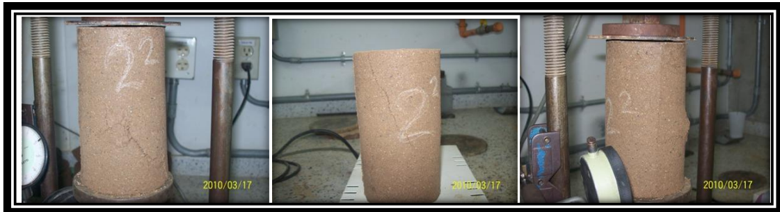
Figura 30. Fallas producidas en las probetas con dosificación 25% finos-40% arenas del suelo con IP. 29.
