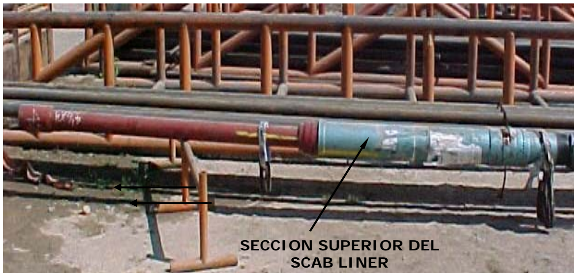
Figura 12. Sección Superior del Empaque Scab Liner, sentado en el pozo MN*-10
