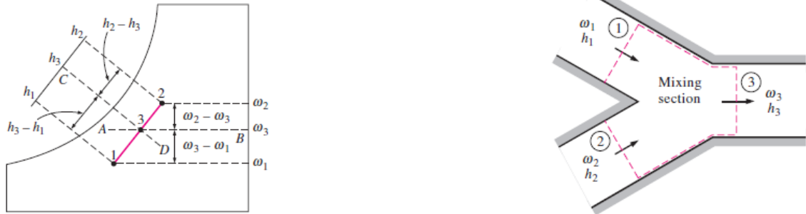
Figura 5. Cuando dos corrientes de aire en los estados 1 y 2 se mezclan adiabáticamente
