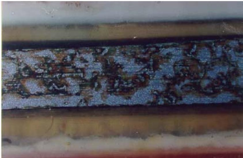
Figura 60. Electrodo de acero al carbono SAE AISI 1020, después de ensayo,  $V_{sl}$  1,18m/s, flujo “slug”, agua destilada, 1% NaCl, aceite,  $N_2$ ,  $CO_2$ , 313°K, 0,135 MPa.
