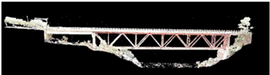
Figura 7. Nube de puntos del puente Guillermo Gómez Ortiz.
