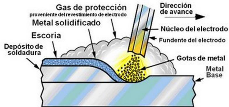
Figura 32. Arco Metálico Protegido (SMAW)
