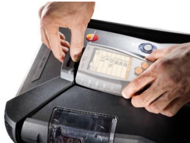
Figura 12. Unidad controladora a punto de ser instalada en la caja de medidas
