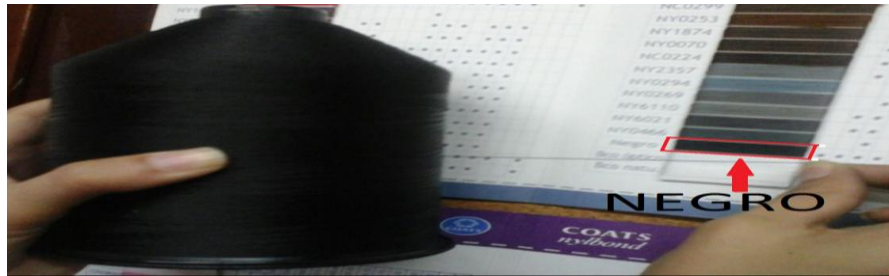
Figura 15. Inspección del color del hilo según patrón NEGRO
