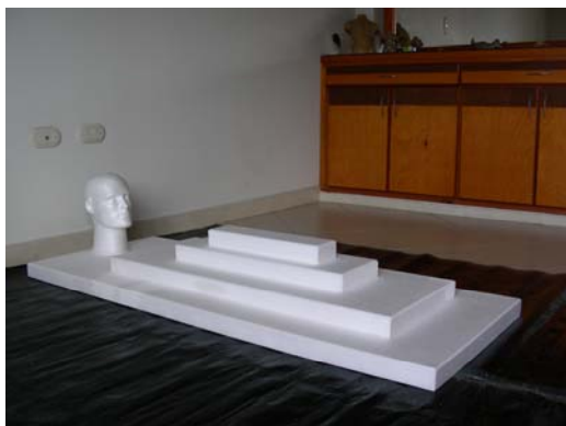
Icopor sobre tela asfáltica
