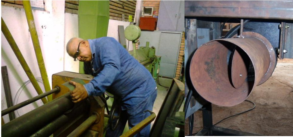
Figura 71. Construcción del la válvula de regulación de aire
