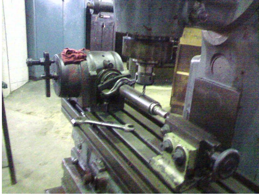
Figura 66. Ranurado de los ejes
