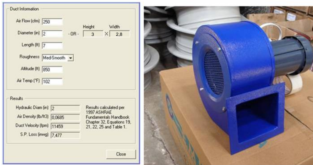
Figura 52. Ventilador centrífugo y especificaciones
