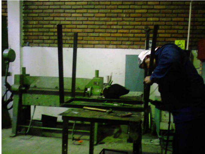
Figura 69. Construcción del soporte del sistema
